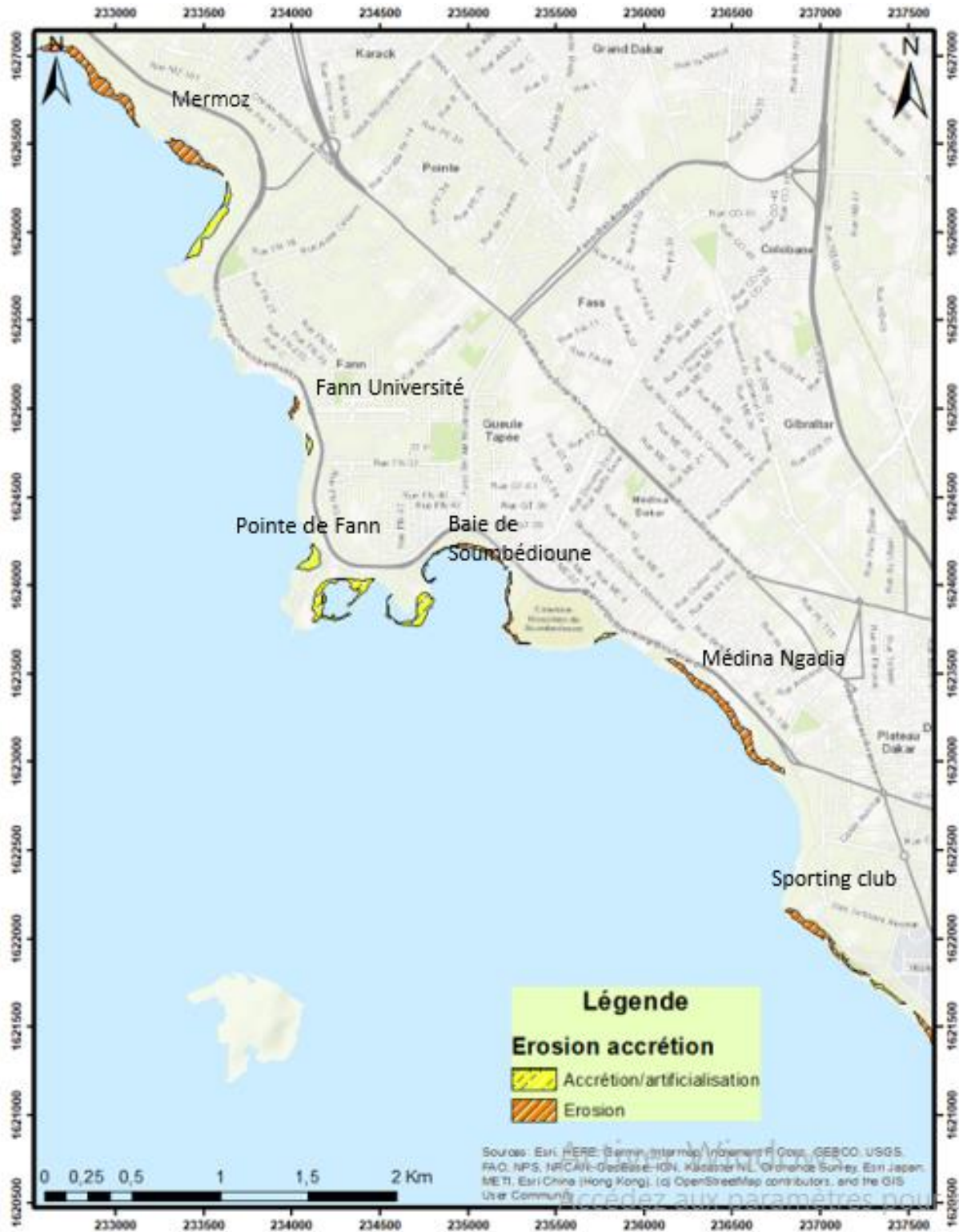
Figure 24: Dynamique du trait de côte au niveau de la Corniche Ouest
