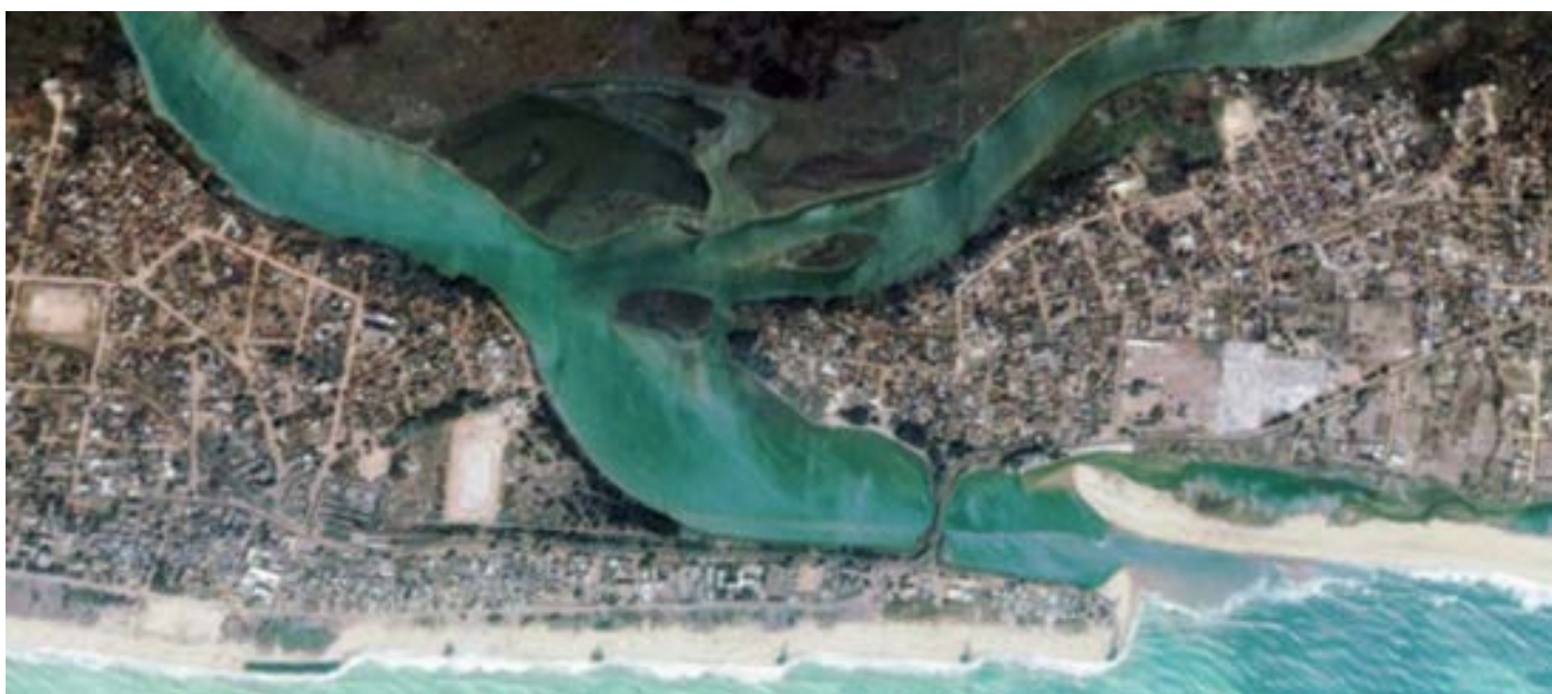
Système fluvio-marin d'Aného (on distingue les épis et enrochements au bas de l'image. (Source Google Earth)
