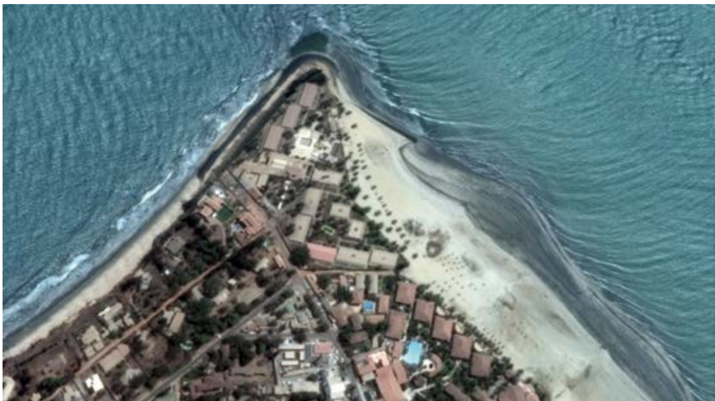
Aménagements à Cape Point (revêtement à l'Ouest de la Pointe, épis courbes remplis à l'Est) (source : Google Earth 2015).
