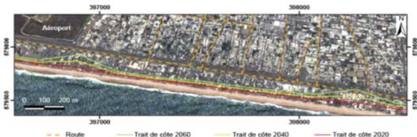
Cinématique future du trait de côte le long de l'autoroute entre Aéroport et Anani (source Koffi et al., 2014)
