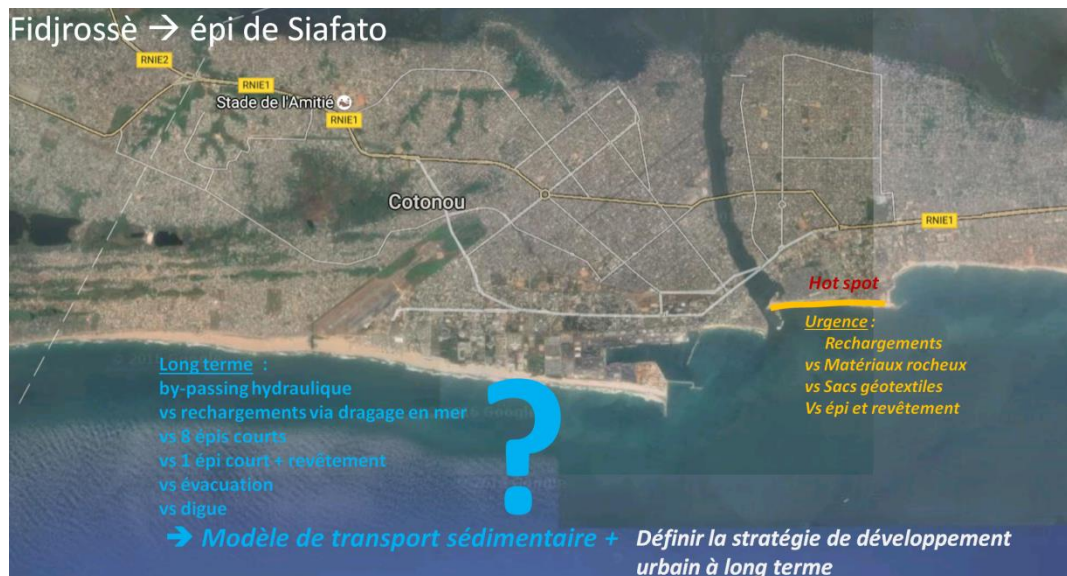
Figure 7.4 Propositions pour le segment Fidjrossè - épi de Sifato.
