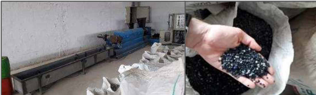
Figure 21 : Ligne d'extrusion du PE - entreprise RECYPLAST ; Côte d'Ivoire (Source SCE 2019)
