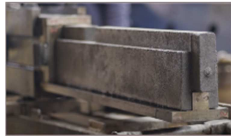
Figure 23 : Briques en sortie d'extrusion dans les ateliers de Conceptos plasticos
